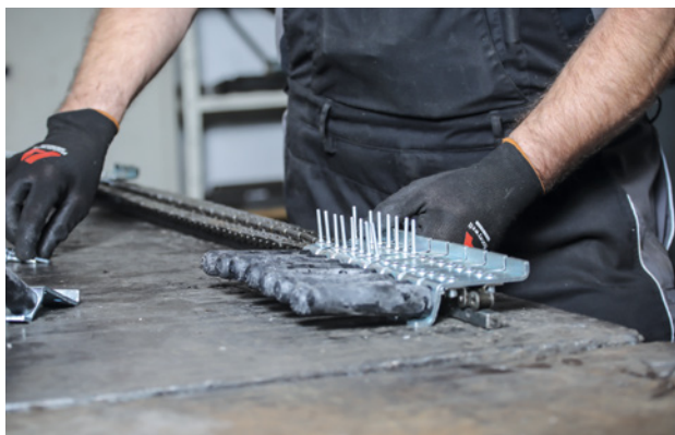
Wir montieren auf Vorrat (Fingerketten passend für Samro und Fördertrangkette passend für Wühlmaus, WM)
