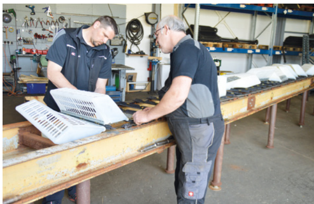
Wir montieren auf Vorrat (Fingerketten passend für Samro und Fördertrangkette passend für Wühlmaus, WM)
